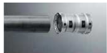
Стальная труба обрезается по размеру и очищается. Затем измеряется и размечается глубина вставки. После этого фитинг Viega Megapress устанавливается на трубу до сделанной отметки.
