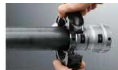
Начиная с диаметра 1 1/4 дюйма, используются пресс-кольца, устанавливаемые по периметру фитинга.
