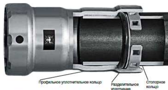
Разделительное уплотнение перед уплотнительным кольцом предотвращает его повреждение при вводе трубы. При опрессовке стопорное кольцо входит в трубу и обеспечивает соединению особую надежность.
