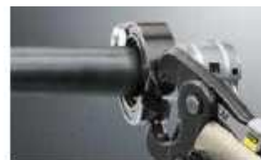
Фитинги Megapress диаметром от 1/2 до 2 дюймов опрессовываются пресс-клещами.
